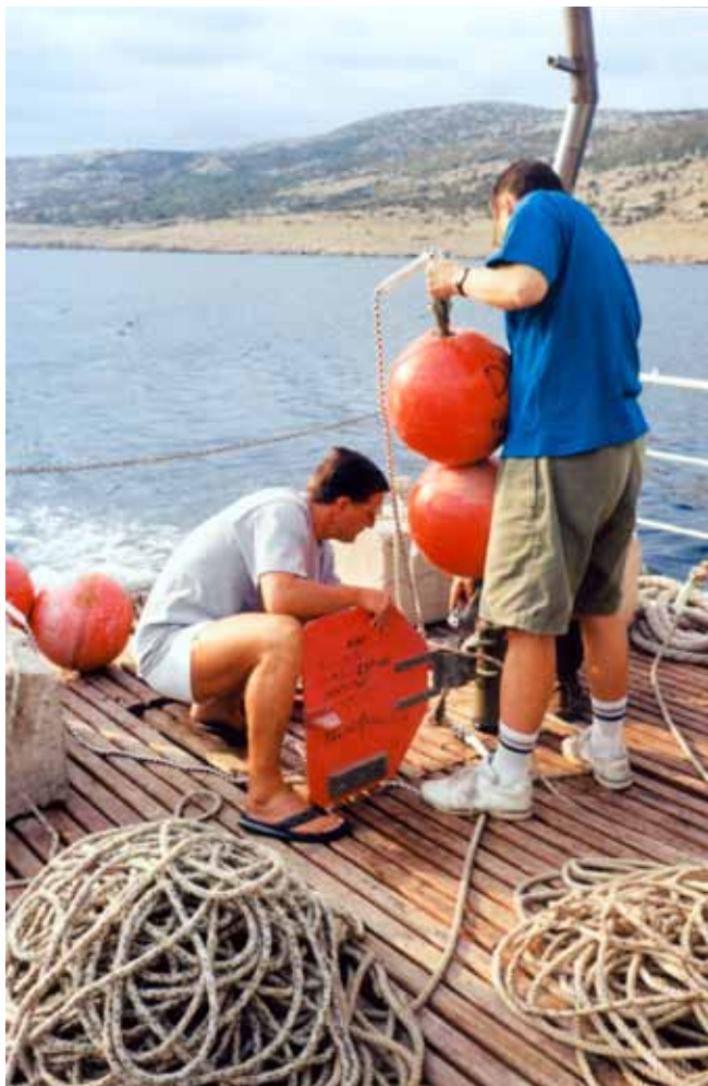
Enad Leder (lijevo) i Mirko Orlić pripremaju strujomjer za postavljanje u Velebitski kanal (istraživački brod Hidra Hrvatskog hidrografskog instituta iz Splita, rujan 1998. godine).
