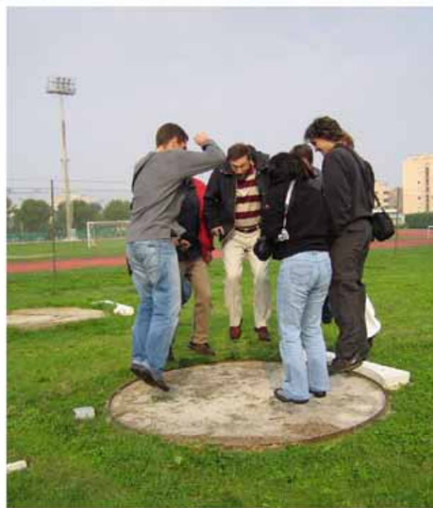
Gore: Mjerenja mikro seizmičkog nemira na nogometnom igralištu u Stonu 2006. godine. Dolje lijevo: Amplifikacija trešnje (DAF) u Stonu procijenjena mjerenjem mikro seizmičkog nemira uspoređena sa štetama (kvadratići) od potresa 1996. godine [160]. Jasnije je vidljivo da su u prosjeku veće štete zabilježene na mjestima gdje je izmjeren veći DAF. Dolje desno: Generiranje "potresa" za mjerenja u Senigalliji (Italija), tijekom radionice u okviru NATO-ovog projekta 2005. godine.
