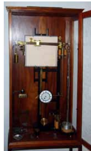
Mikrobarograf Sprung-Fuess, instaliran na Opservatoriju 1903. godine. Instrument radi na principu vage s povratnom spregom i postiže preciznost bolju od 0.1 mm Hg. Zapisao je pad meteora u Tunguski u Sibiru 1908. godine. Ovaj vrlo rijedak instrument (jedan od dva preostala primjerka u svijetu) danas je u ispravnom stanju izložen u Memorijalnim prostorijama A. Mohorovičića na Geofizičkom odsjeku PMF-a u Zagrebu.
