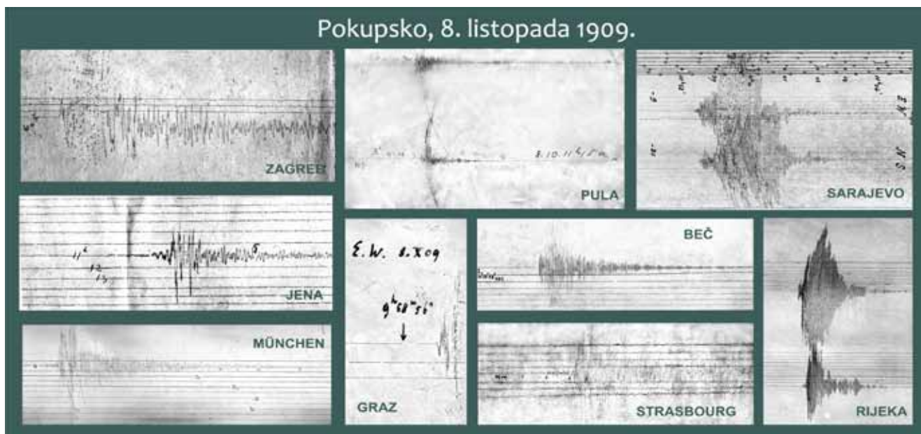
Slika 21. Nekoliko seizmograma pokupskog potresa od 8. listopada 1909. Analizirajući ih, Andrija Mohorovičić je zaključio da mora postojati diskontinuitet u unutrašnjosti Zemlje [306].
