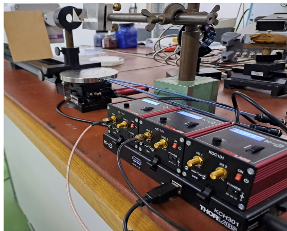
Slika 6: Pomično postolje s koračnim motorima i mikrokontrolerima.
