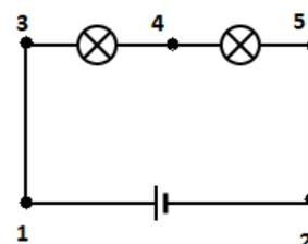
4. Strujni krug na slici sadrži bateriju napona 4,5 V i dva otpornika. Otpor otpornika  $R_1$  dva puta je veći od otpora  $R_2$ . Predvidite sljedeće napone:
