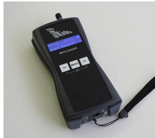
Slika 14. Ultrazvučni detektor (bat detektor) Elekon BATLOGGER M
