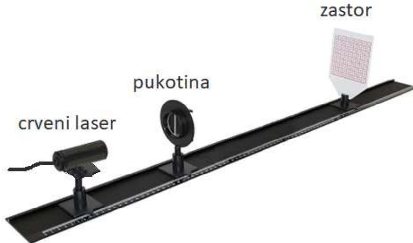
Uključite laser i usmjerite ga na usku pukotinu.
