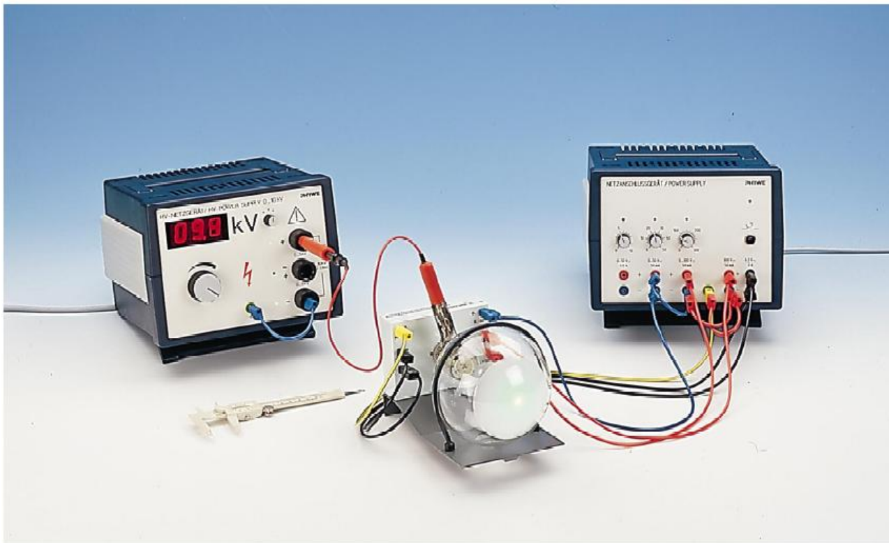
Slika 4: Eksperimentalni postav za elektronsku difrakciju.
