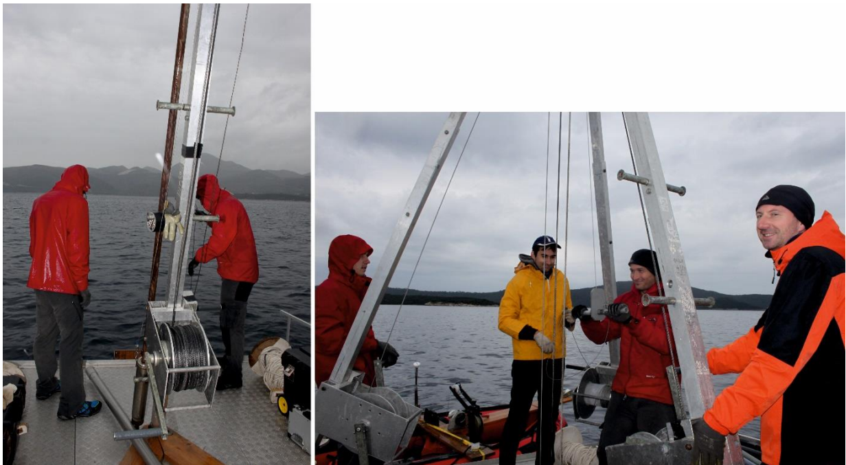
Slika 4.4. Uzorkovanje jezgre u Koločepskom kanalu pomoću plutajuće platforme „Q2“ s tornjem, vitlima i klipnim jezgrilom.
